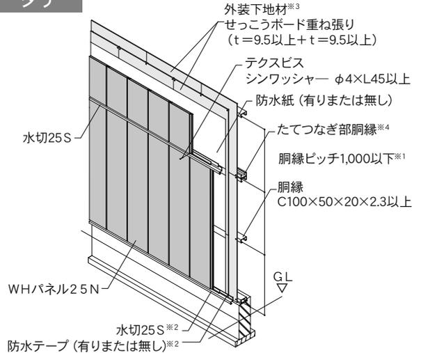
※1：パネル、下地材自体の風圧許容荷重によって銅縁ピッチが制限される場合があります。
