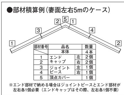
※施工前にエンド、ジョイント、頂点部を積算して必ずご発注ください。本部材を使用されない防水性が確保できません。
