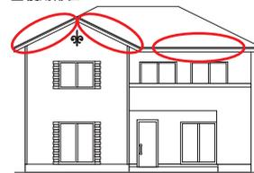
妻壁用の通気見切りをラインナップ。すべての外壁面での通気を可能とし住宅の耐久性を向上させます。
