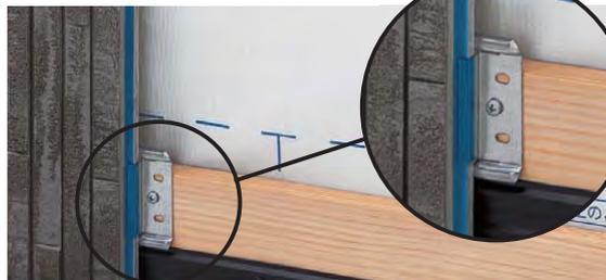
同質出隅の端面を段付き形状とし、専用留め金具を使用することにより、縦張り金具留め(5mm)の施工も可能です。
