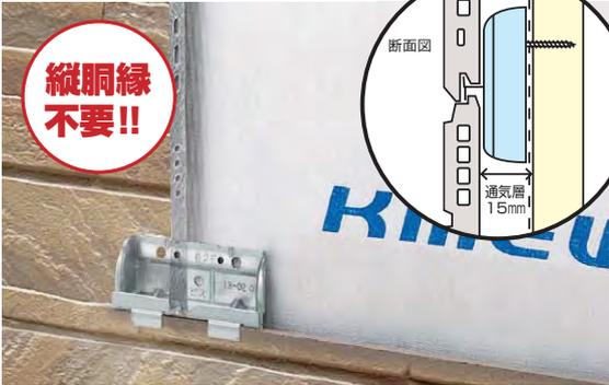
「通気金具」を使って外壁材を施工するだけで、従来のように縦胴縁を設けることなく、簡単に15mmの通気層をつくることができます。
