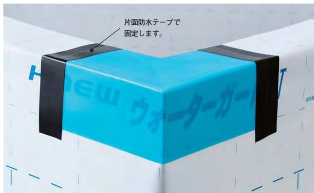
※透湿防水シートを施工後、ポイントガードⅢを取り付けて片面防水テープ(品番B4031、B423、B424、RE405)で固定してください。
