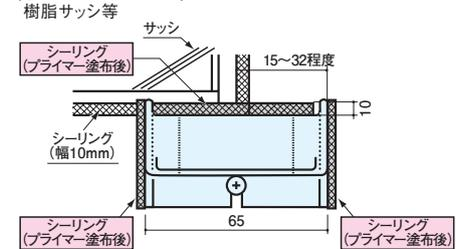
※お願い) 上図の 部位には必ずプライマー塗布後シーリングをしてください。特に上部のシーリングがない場合、雨水が滞留し外壁材に悪影響を及ぼします。
