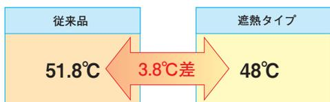
シート裏面で温度が3.8℃下がっており遮熱タイプは壁体内への熱の侵入をふせいでいます。
