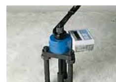
③ 床面の凹凸に合わせて脚の高さを調節
