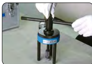
② アンカーにカップリングをねじ込む
