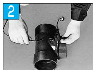
固定具をワイヤーで二重に巻きつけます。ワイヤーは継手受口の段差部にかかるように巻きつけます。
