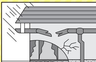
モルタル壁などにクラックがあると、そこから雨水が壁の中に入り柱や土台を腐食させます。
