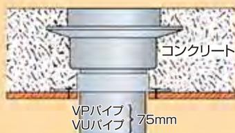
(3) 各キャップ (ルーフドレーン用 (RD-E)、バルコニードレーン用 (RD-H)) を差し込み廻して固定する。キャップを抜き取る場合、キャップを引き上げて廻せば取れます。
