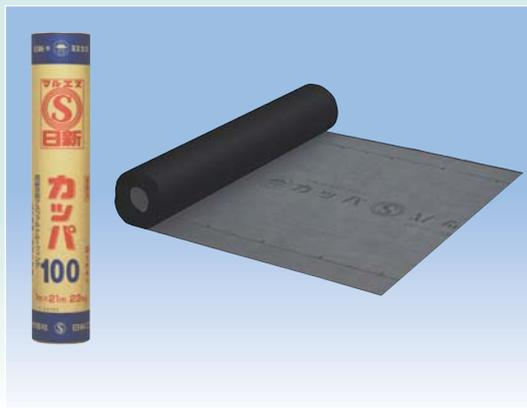
高品質の厚手合成繊維不織布に、改質アスファルトを浸透・被覆し、裏面に薄手合成繊維不織布を張り合わせた高耐久の製品です。引張性能・伸び・引裂性能に優れています。更に、柔軟性が高いことで施工性にも優れています。
