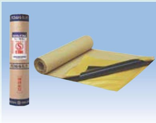
合成繊維不織布と合成繊維メッシュに改質アスファルトを浸透・被覆した両面粘着層付アスファルトルーフィングです。
