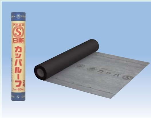
改質アスファルトを2枚の合成繊維不織布で挟んで一体化した製品です。表面は珪物質粉粒仕上げを施し、さらに特殊合成樹脂によるカラー層を設けた滑りにくい高耐久の製品です。他の製品と比較し、軽量、カッターによる裁断のしやすさ、立上りや入隅施工時の折り曲げのしやすさが特徴です。
