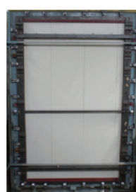
Pic-02 水密試験体屋内側
