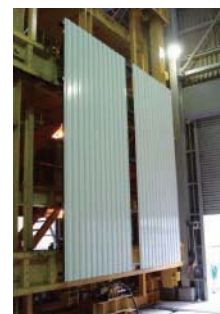
<層間変位追従性能試験>
